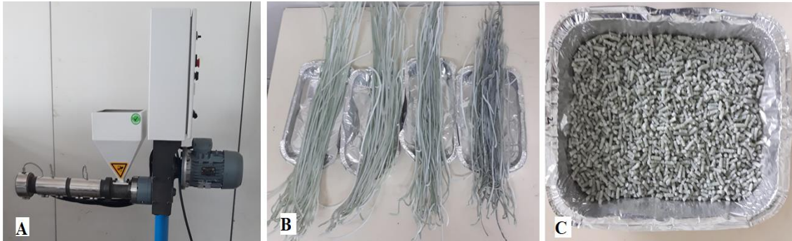
Şekil 1. Araştırmada kullanılan extruder (A), filamentler (B) ve peletler (C)
