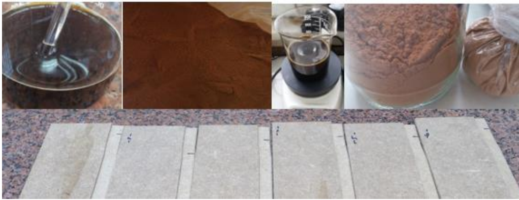
Şekil 2. Çalışmada kullanılan kalsiyum lignosülfonat kimyasalı ve üretilen levhalar
