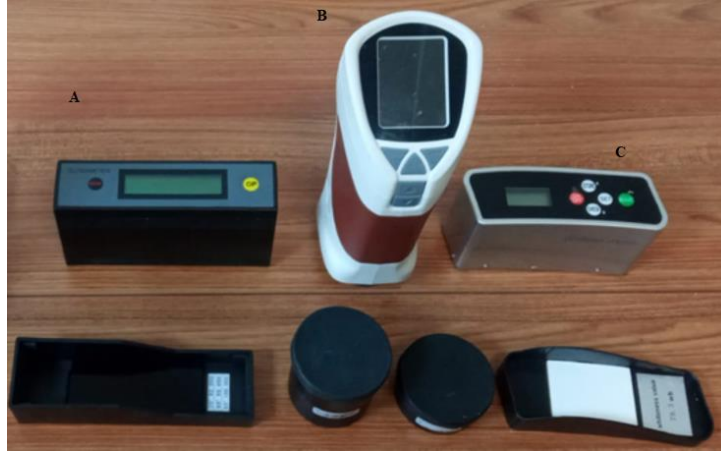
Şekil 2. Parlaklık ölçüm cihazı (A), renk ölçüm cihazı (B) ve beyazlık indeksi ( WI^* ) ölçüm cihazı (C)
