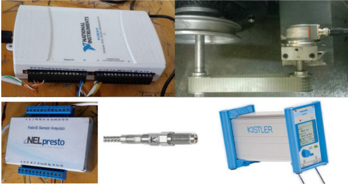
Şekil 5. Silindir basıncı ölçüm sistemi ekipmanları
