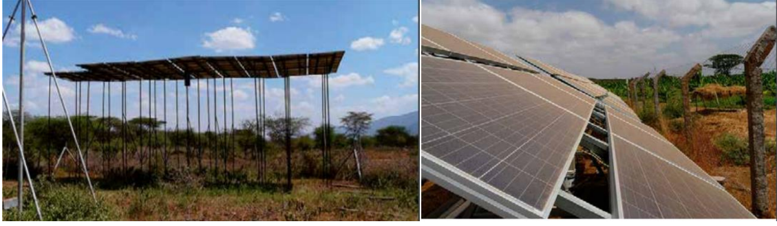
Görsel 4. Solda: PV Modüllerin Yatay Kurulumu, Sağda: PV Modüllerin Gölgelemesi
